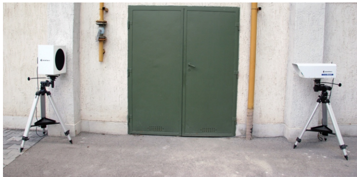
A fix telepítés mellett állvánnyal is használható, de az infravörös forrást esőtől védett helyre kell telepíteni.
