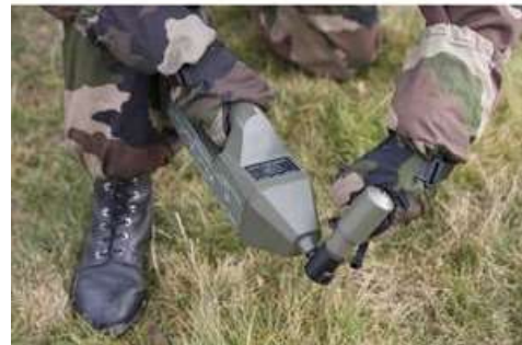
Folyadék és szilárd és minták detektálása az S4PE adapterrel.
